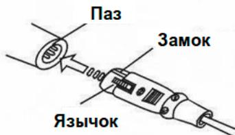
1. Присоедините соединительный провод к микрофону. Для этого выровняйте разъем провода так, чтобы замки на нем располагались напротив соответствующих пазов на корпусе микрофона. Затем вставьте разъем в корпус микрофона и прижмите до щелчка. Чтобы отсоединить провод от корпуса микрофона, нажмите на язычок и потяните за разъем провода, удерживая корпус микрофона другой рукой.
