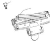
Установите ролик обратно внутрь корпуса насадки. Ролик может быть установлен только одной стороной. Закройте крышку насадки и зафиксируйте ее замком.
