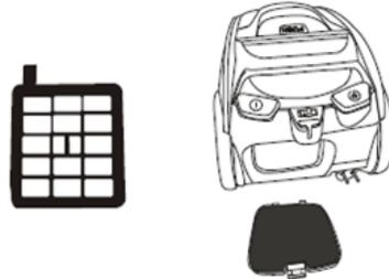
Снимите воздуховыпускную решетку и извлеките фильтр. Почистите фильтр щеткой. При сильном загрязнении промойте его прохладной водой под краном. Дайте фильтру полностью высохнуть естественным способом. Установите фильтр обратно, а затем воздуховыпускную решетку.
