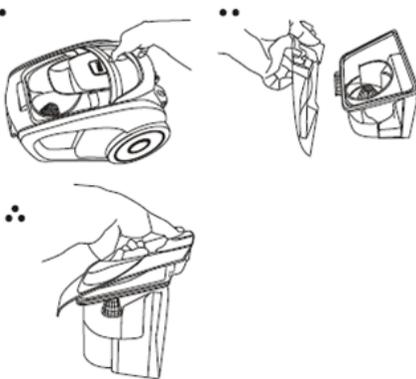
Снимите контейнер для сбора пыли, нажав на кнопку. Откройте крышку контейнера и вытряхните пыль. Вымойте фильтр водой, затем дайте высохнуть естественным способом. Затем установите контейнер с фильтром на пылесос.
