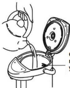
2. С помощью другого сосуда залейте в чайник-термос чистую воду до максимальной отметки.
