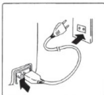
4. Присоедините шнур питания к чайнику-термосу, затем вилку шнура питания подключите к электрической розетке.
