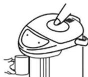
8. Подставьте под носик чайника-термоса чашку и нажимайте на площадку механической помпы, чтобы налить воду.
